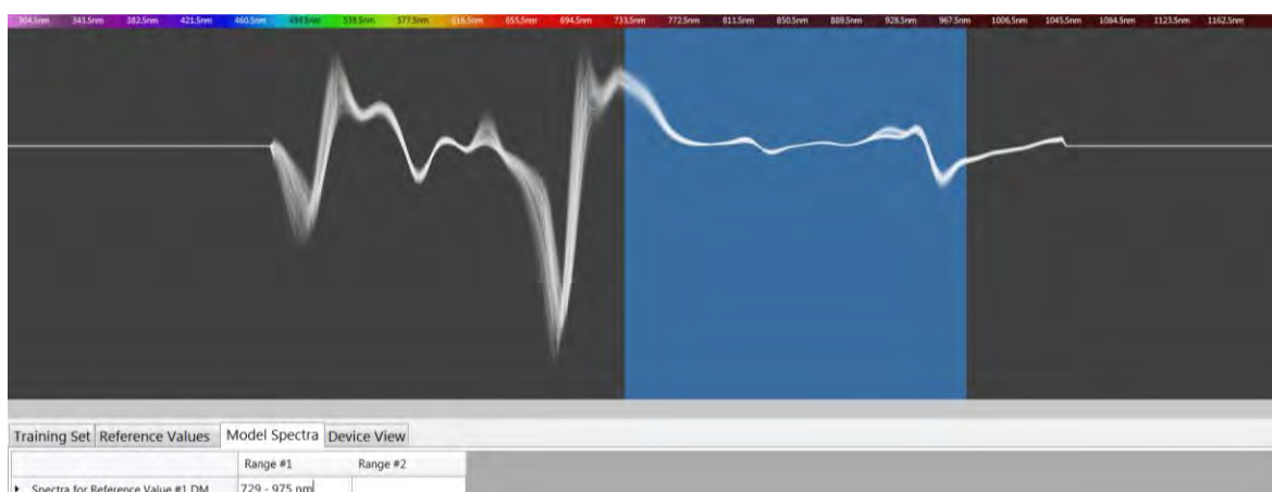
Figura 3. Bandas espectrales de frutos de aguacate ‘Hass’ de diferente contenido de MS, construidos por el software del espectrómetro F-750.
