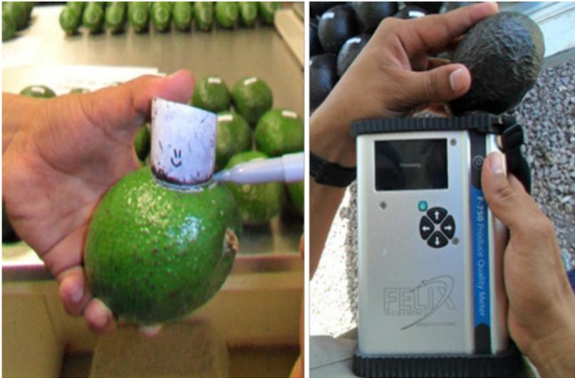
**Figura 23. Zona de lectura (dorsal superior) con el espectrómetro F-750 para frutos de aguacate Hass.**
